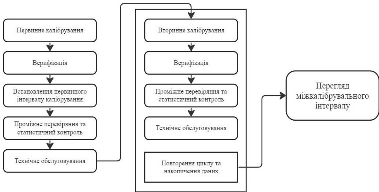
Рис. 1 – Загальна схема забезпечення якості функціонування вимірювального обладнання як компоненту технології зберігання та переробки зерна
