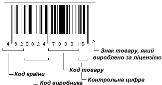
Рис. 3.2. Зовнішній вигляд і структура коду EAN-13
