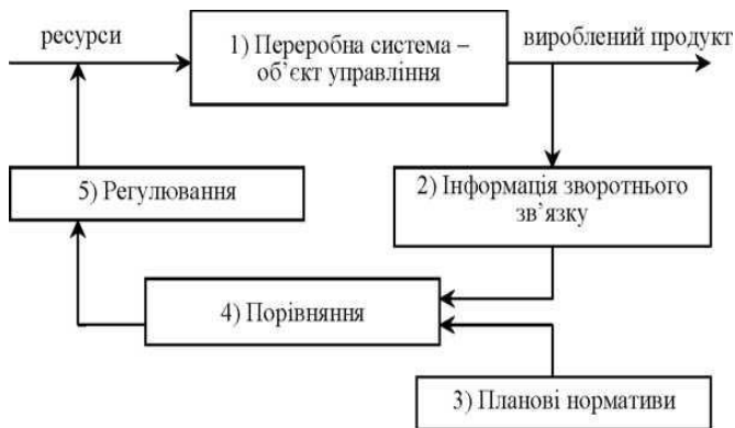
Рис. 1.20. Модель загального процесу оперативного управління виробництвом
